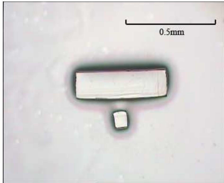
a. As-grown  $\text{NaBeB}_3\text{O}_6$  crystal
