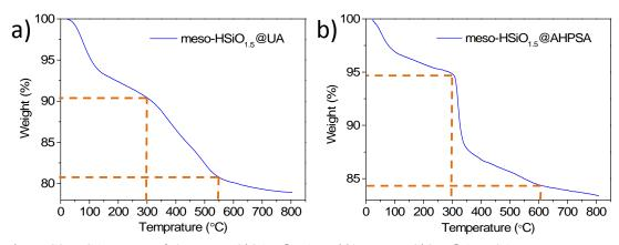
Figure S2: TGA curves of a) meso-HSiO1.5@UA and b) meso-HSiO<sub>1.5</sub>@AHPSA.
