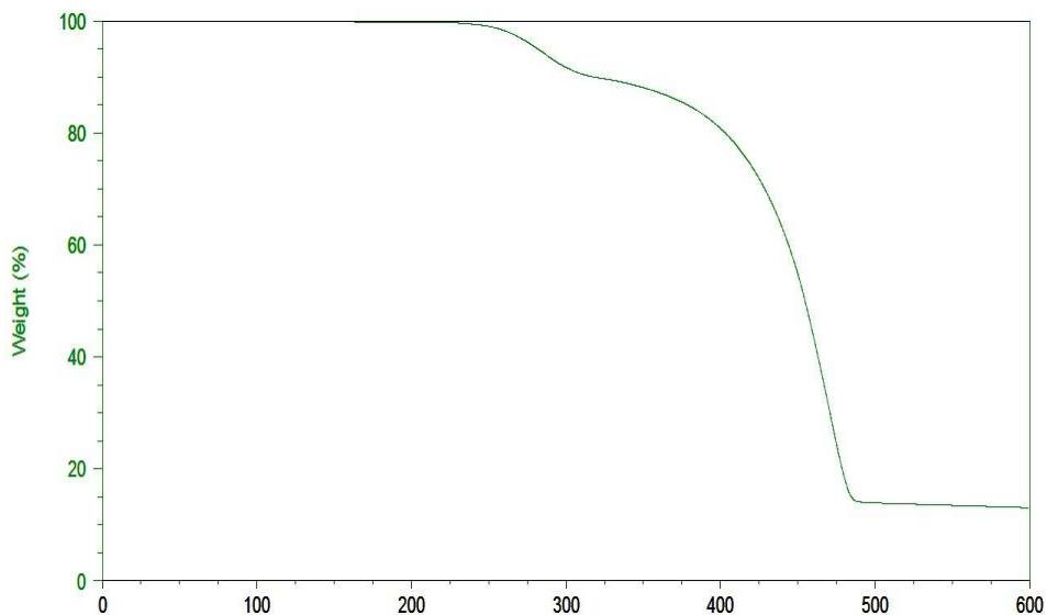
**Fig. S67** TGA curve of IM(1O1)12-TFSA.
