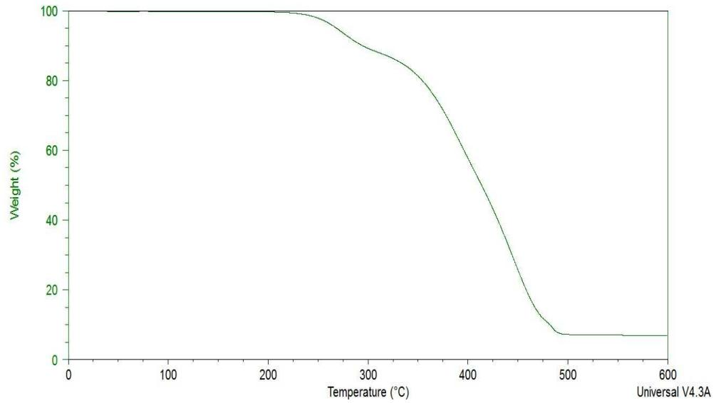
**Fig. S73** TGA curve of IM(1O1)22-TFSA.
