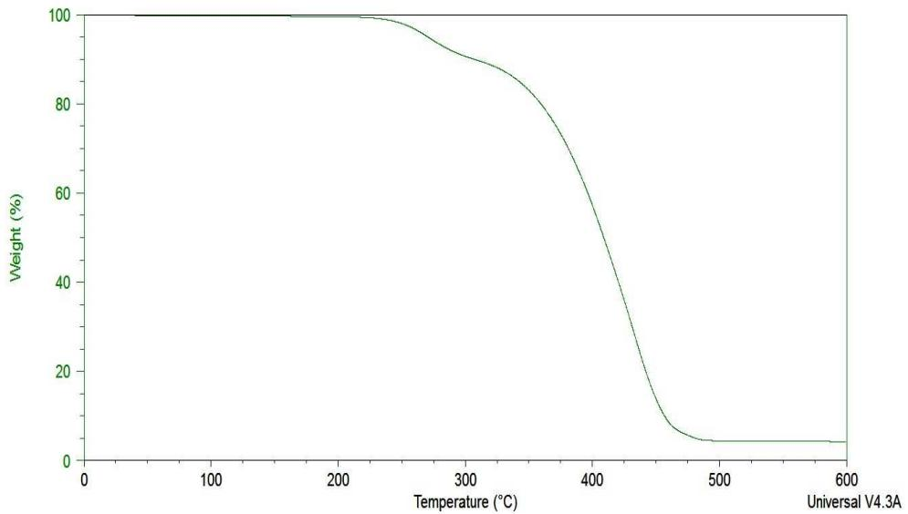
**Fig. S77** TGA curve of IM(1O1)2(2O2)-TFSA.
